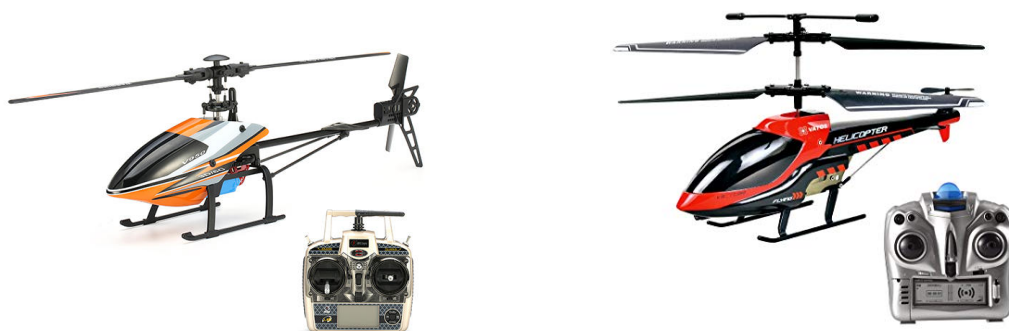
Слика 20: Коптери са једним (лево) и два (десно) ротора
