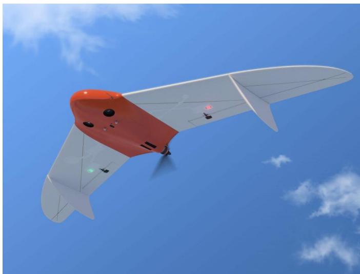
Слика 19: Беспилотни ваздухоплов са чврстим крилима, Geoscan 201
